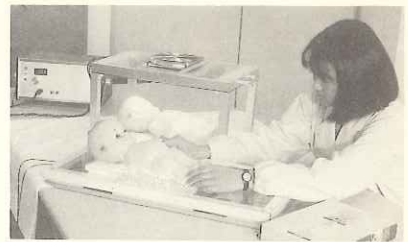
写真-2 筆者の開発した青色・青緑色LEDを用いた新生児黄疸光線治療装置
