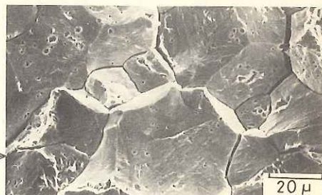
写真-2 遅れ破壊クラック伝播部の典型的旧オーステナイト粒界割れ
