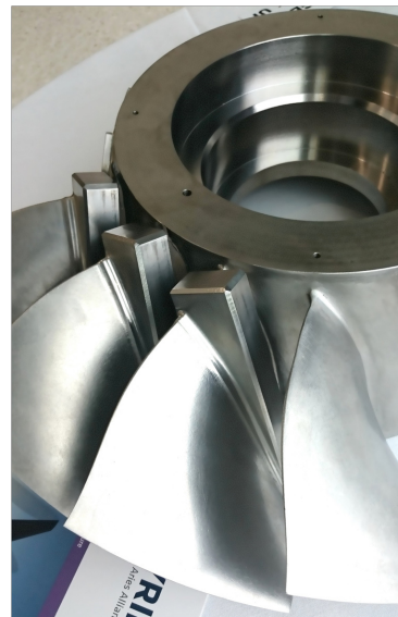
図 2 Ti-6Al-4V 合金一体型ブレードディスク
