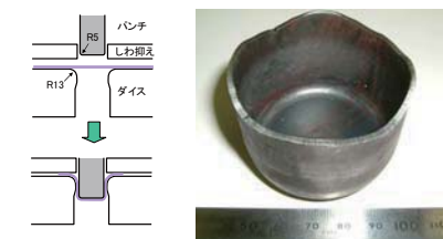
図5. 超微細粒薄鋼板の深絞り試験結果
