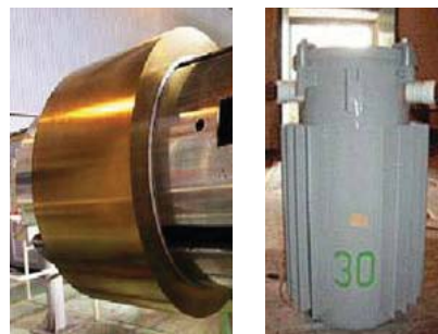
図-5 TiN成膜コイルと試作変圧器の外観
