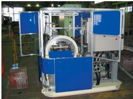
図 - 1 高融点生体用特殊合金溶製・鋳造装置プロトタイプ機 BIO CASTER FFK-50
