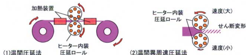
図-2 高成形性板材の開発で用いる圧延方法
