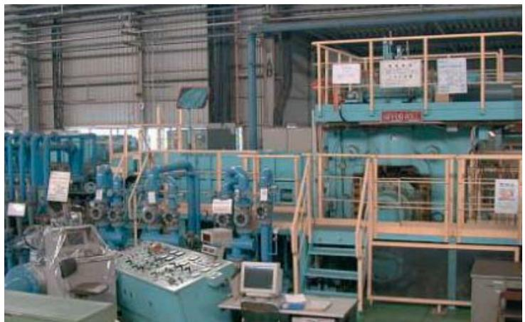
写真 - 2 本プロジェクトで導入した多機能統合型実験圧延設備
